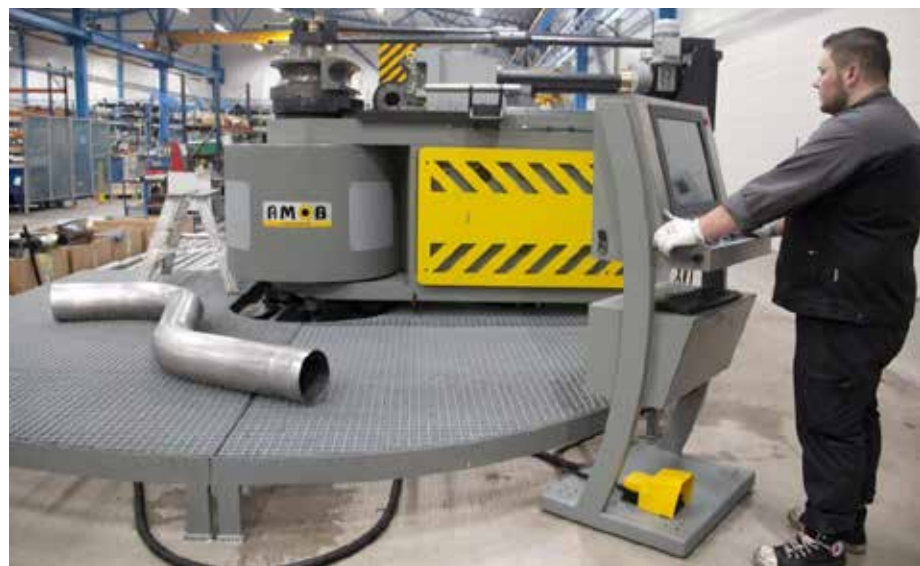
Joros 70 järnhårda proffs drar försorg om produkternas kvalitet, effektiviteten i verksamheten och försörjningstryggheten. Rörbockningsmaskinen på bilden har bockningskapaciteten DN200 med en 13 millimeter tjock rörvägg.
