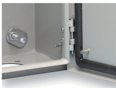
Kotelon pohjassa on hitsatut M8-pultit ja ovenssa M6-pultit. Yhdellä sivulla on lisäksi maadoitukseen tarkoitettu M6-pultti. EFLM4 kiinnityskorvan kiinnitys - laatta on lisätarvike. Tilattava erikseen.
