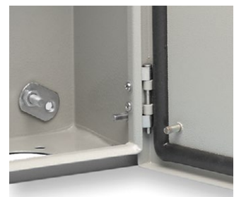
Kotelon pohjassa on hitsatut M8-pultit ja ovesa M6-pultit. Yhdellä sivulla on lisäksi maadoitukseen tarkoitettu M6-pultti.
